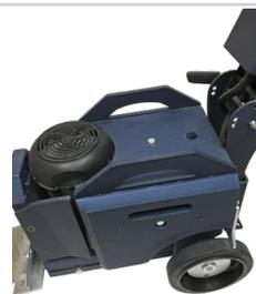
El diseño incorpora la base, manija soporte, tanque hidráulico y soporte del motor en un solo componente muy fuerte. Esto reduce la cantidad de sujetadores necesario para montar la estructura.
