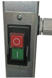
El interruptor de encendido magnético mantendrá la máquina de no iniciar accidentalmente si el cable de accidente desconecta y reconecta durante operación.
