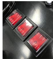
ENCENDIDO / APAGADO POR CARACTERÍSTICA DEL INTERRUPTOR DEL MOTOR
