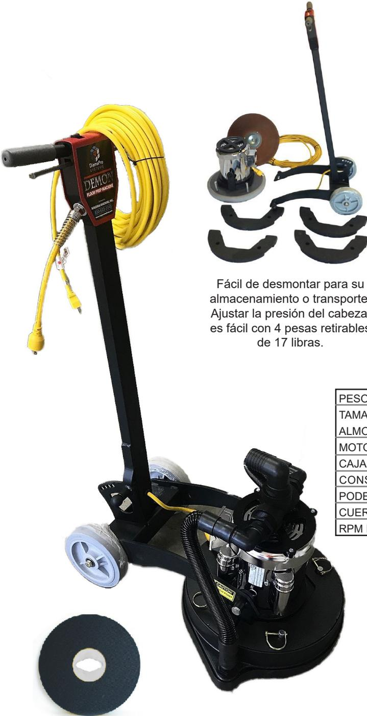
Fácil de desmontar para su almacenamiento o transporte. Ajustar la presión del cabezal es fácil con 4 pesas retirables de 17 libras.
